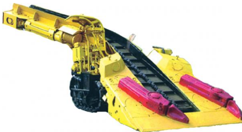
Рис. 6.17. Породонавантажувальна машина безперервної дії на гусеничному ході
