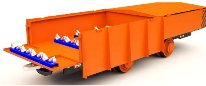
Рис. 6.6. Спеціальна шахтна вагонетка для транспортування кисневих балонів
