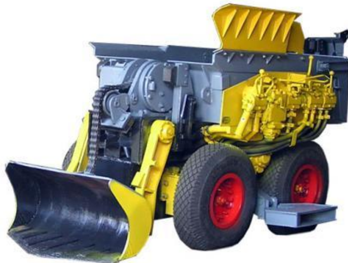
Рис. 6.16. Породонавантажувальна машина періодичної дії на пневмошиному ході
