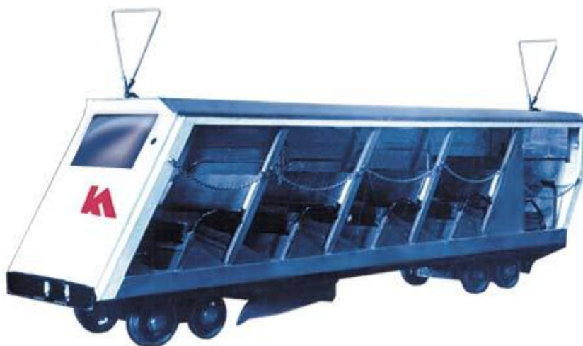
Рис. 6.10. Шахтна вагонетка для перевезення людей по похилим виробкам
