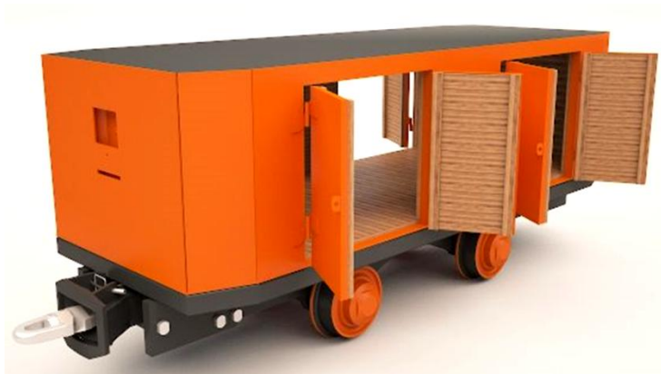
Рис. 6.7. Спеціальна шахтна вагонетка для транспортування вибухових матеріалів
