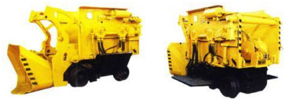
Рис. 6.15. Породонавантажувальна машина періодичної дії на колісно-рейковому ході
