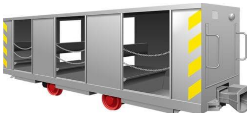
Рис. 6.9. Шахтна вагонетка для перевезення людей по горизонтальним виробкам
