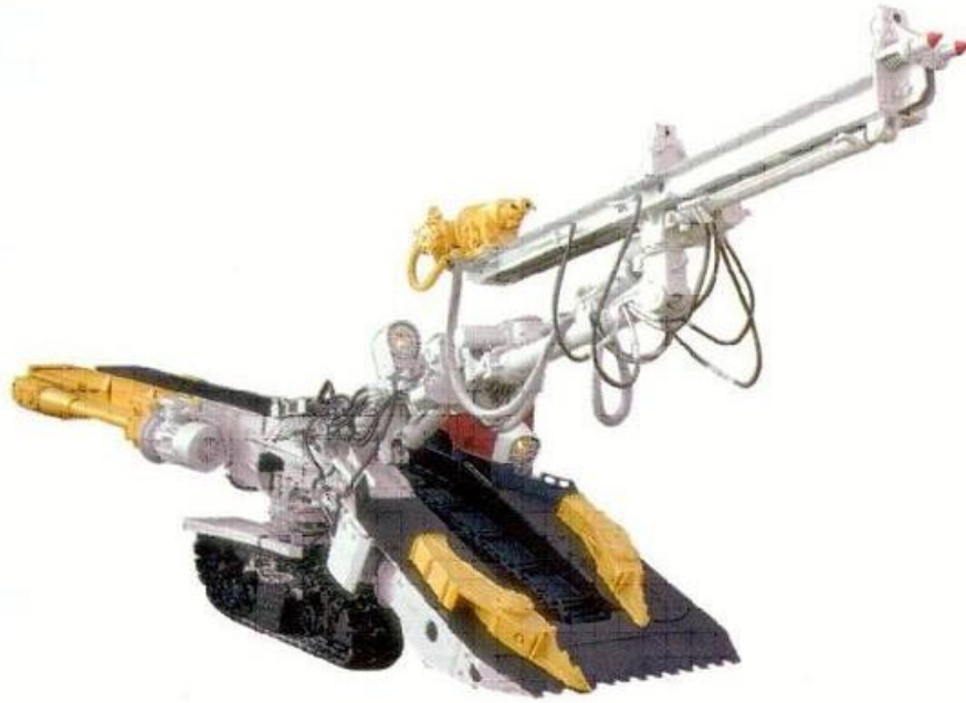
Рис. 6.17. Породонавантажувальна машина безперервної дії на гусеничному ході з функцією буріння шпурів
