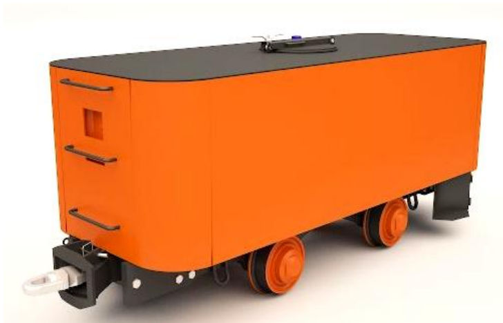
Рис. 6.8. Спеціальна шахтна вагонетка для транспортування паливно-мастільних матеріалів
